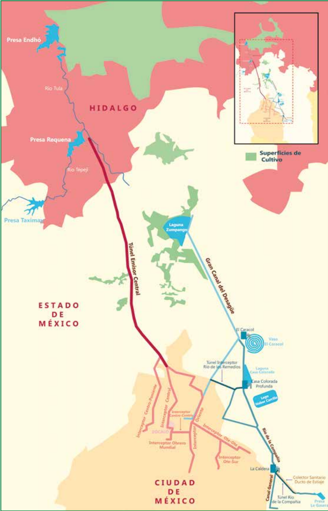
FIGURA 13. Principales elementos del Sistema del Drenaje Profundo
