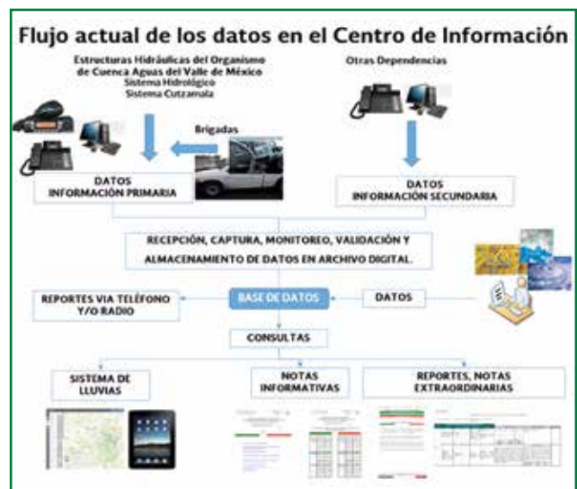
FIGURA 5. Esquema del funcionamiento del centro de información OCAVM
